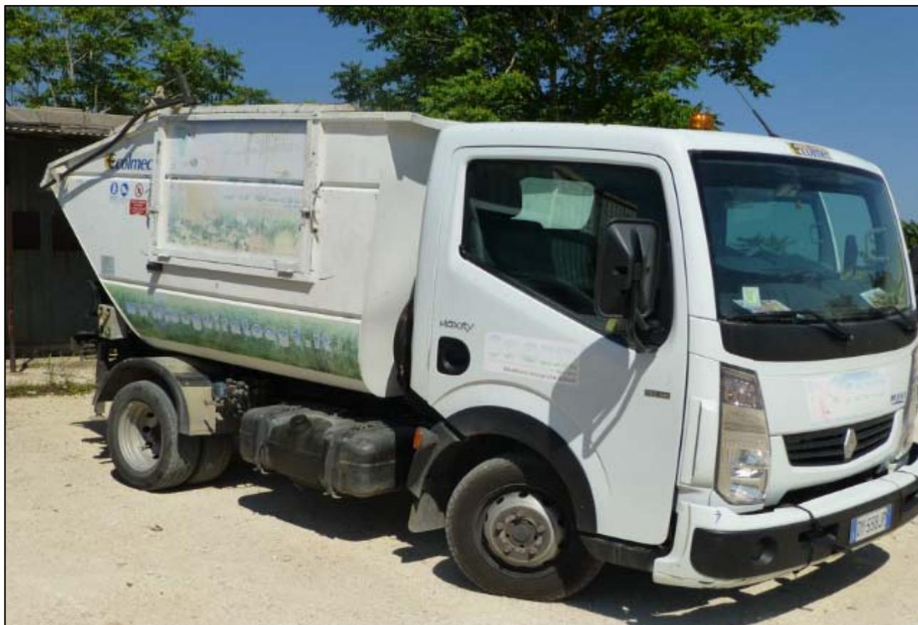
**Immagine 2 Mezzo con pianale di carico utilizzato per la raccolta di RAEE e ingombranti**
